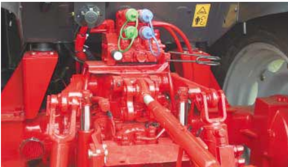
Im Heck sind bis zu vier Steuergeräte möglich. Mit den beiden außen liegenden Zusatzzylindern beträgt laut Hersteller die Hubkraft beachtliche 3400 kg.
