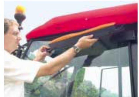
Zwei Luftfiltereinsätze im Kabinendach sorgen für saubere Luft in der Kabine.
