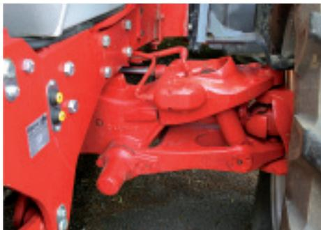
Die Einzelrad-Vorderachsfederung erhielt großes Lob vom Testteam. Der Federweg beträgt +/-45 mm.
