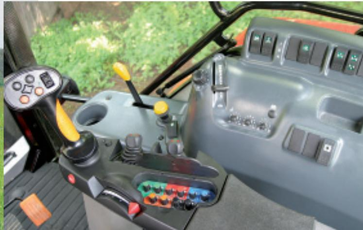
◀ McCormick bietet beim XTX drei Modell-Versionen an. Die E-plus-Ausführung zeichnet sich durch eine elektronische Betätigung der Zusatzsteuergeräte über die Armlehne aus.
