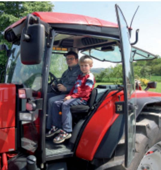
Die Kabine hat keine B-Säule. Weit öffnende Türen erleichtern den Aufstieg. In der geräumigen Kabine ist auch für einen Beifahrer ausreichend Platz.
